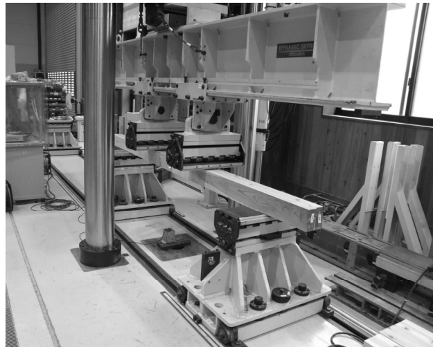
図1 スギ材の実大曲げ試験
