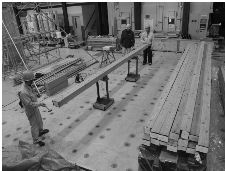
写真1 実際の動的ヤング率の測定の様子
